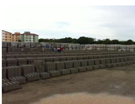
Foto 14: blocos sendo paletizados
